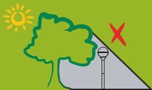
Può sembrare un'osservazione banale, ma talvolta può capitare di montare i lampioncini solari posizionati dove il sole in realtà batte per poche ore al giorno (o addirittura collocati in ombra...): questo porta un'autonomia notturna molto limitata o quasi nulla.
