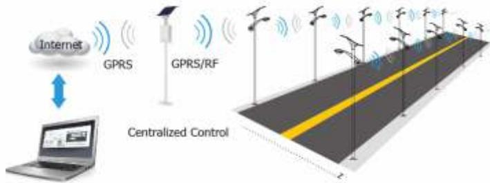
L'accesso Remoto al Server avviene tramite computer o telefono cellulare, il quale ci permette di gestire e inviare dei comandi al controller intelligente tramite rete Internet o GPRS i quali, a loro volta, verranno inviati tramite segnale wireless alle luci ottenendo, così, un controllo ottimale della quantità di luce erogata.
